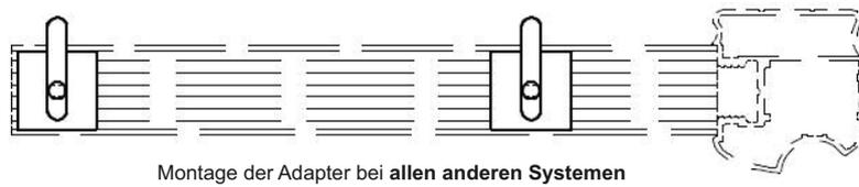
Abb. 6 Dämpfermontage
